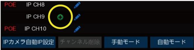
5. 手動モードに変更後、カメラを検索するとカメラがリストアップされます。
