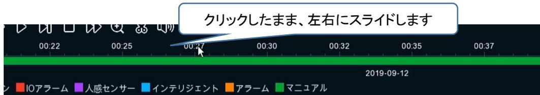
表示時間を移動したい場合は、タイムバー上の時間表示部分をマウス左ボタンでクリックしたまま左右にスライドします。
