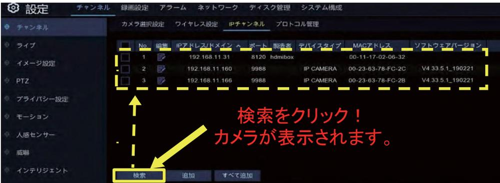
6. カメラのIPアドレスの変更が必要な場合はカメラの
