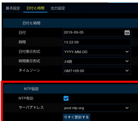
NTP を有効にしサーバーアドレスを選択し、**適用**をクリックして設定を保存します
