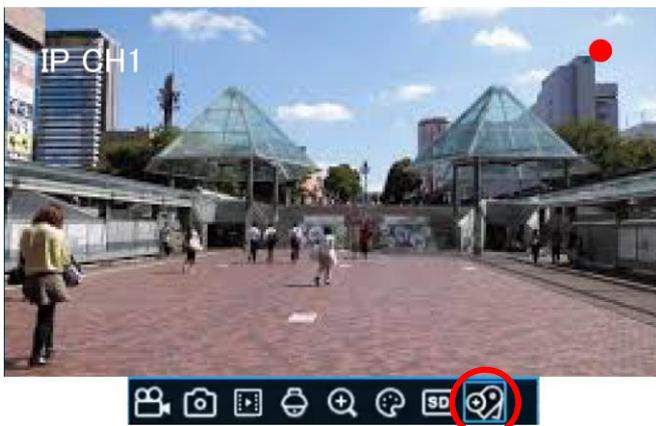
ライブ画面のカメラクイックツールバーからリアルタイム映像のカスタムタグを作成します。
